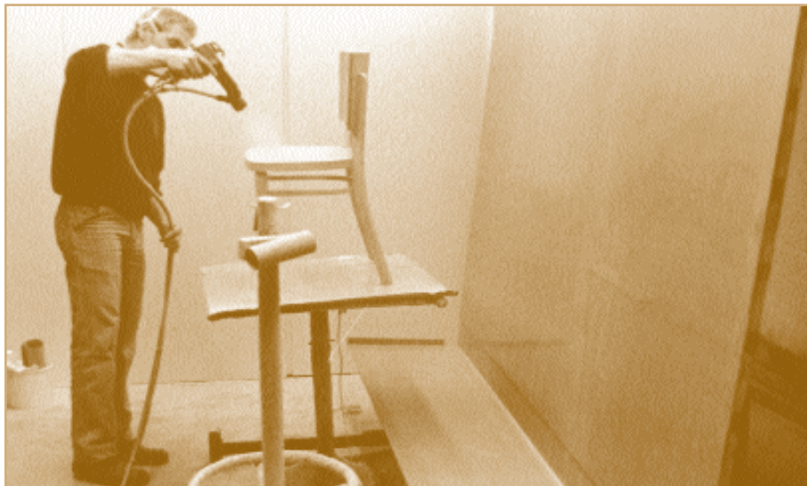
Het aanbrengen van 1K-watergedragen lak. Terugwinning vindt plaats via een 'Coolac-wand' (rechts). (Foto: Inge Bergevoet)
