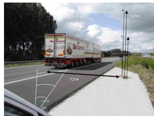
figuur 2 Meetopstelling volgens de SPB-methode
