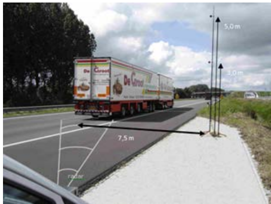
Meetopstelling volgens de SPB-methode
