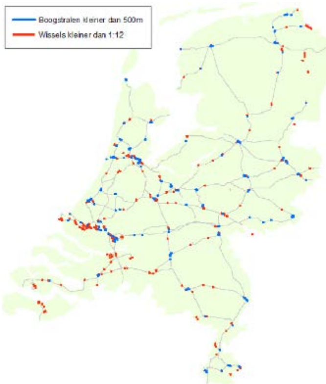
Figuur 8: Locaties met bogen en wisselbogen. [bron: dBvision rapport CNOSSOS railverkeer - Bronkentallen en adviezen voor implementatie van rekenmethode CNOSSOS voor railverkeer in Nederland, dec 2017]
