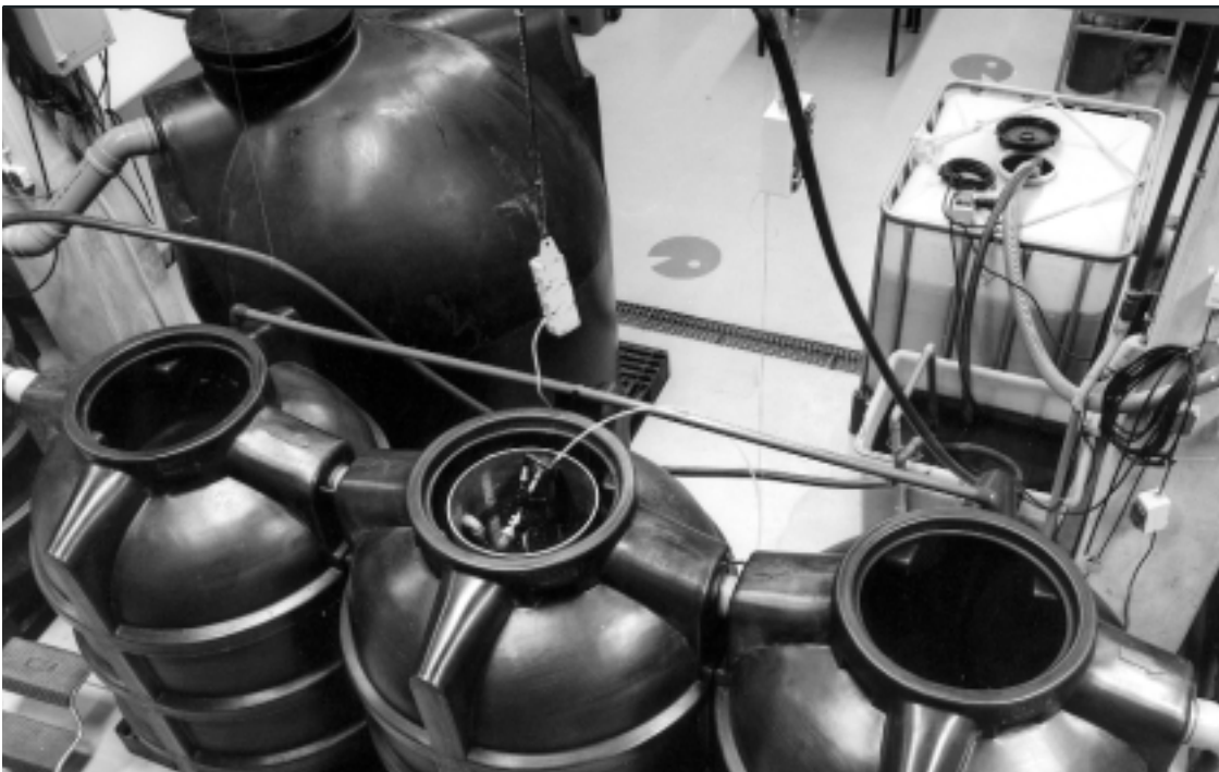
Aktief slib systeem met voor- en nabezinker (laboratoriumopstelling)
