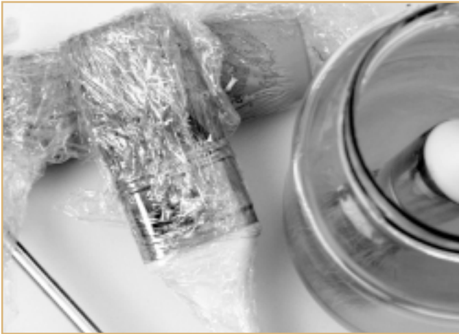
Gebruiksduur van rollers en kwasten verlengen door ze luchtdicht te verpakken
